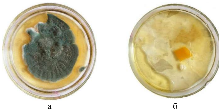
Рисунок 71 – Фотографии шелковой ткани после испытаний на стойкость к воздействию плесневых грибов: а – необработанный образец;
