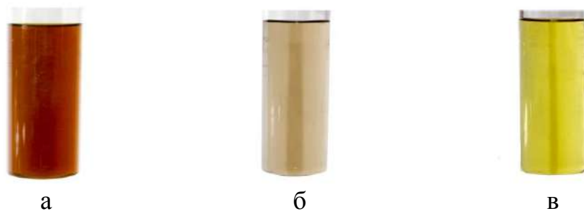
Рисунок 21 – Фотографии коллоидных растворов бicomпонентных наночастиц Cu-Ag: а – концентрации прекурсоров Cu 0,5 мМ, Ag 0,5 мМ; б – концентрации прекурсоров Cu 0,3 мМ, Ag 0,1 мМ; в – концентрации прекурсоров Cu 0,3 мМ, Ag 0,2 мМ
