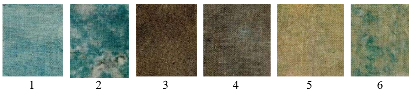
Рисунок 46 – Образцы хлопчатобумажной ткани, обработанные раствором метиленового голубого: 1 – исходный образец, 2 – образец, выдержанный в почве; 3 – образец с НЧ Cu-Ag; 4 – образец с НЧ Cu-Ag, выдержанный в почве; 5 – образец с НЧ Ag; 6 – образец с НЧ Ag, выдержанный в почве
