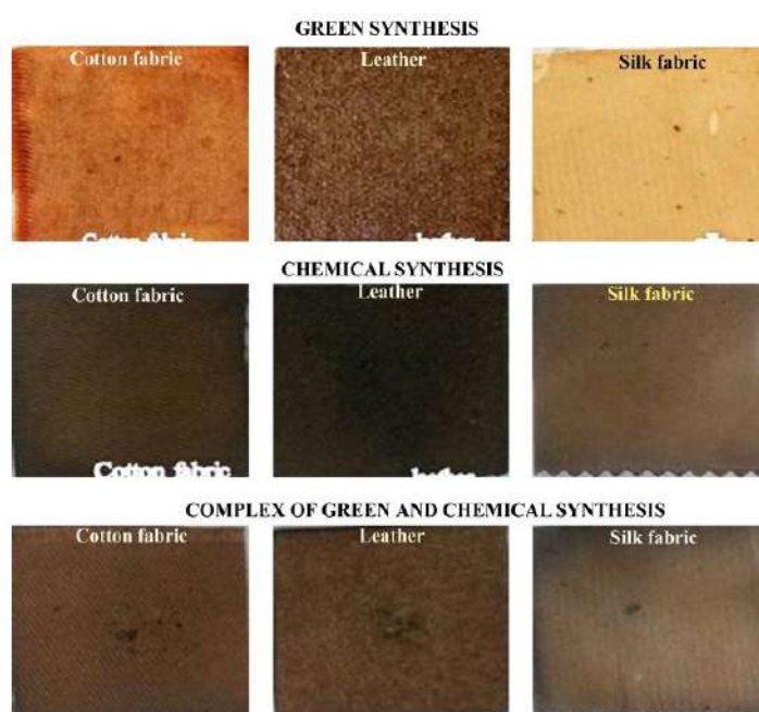
Рисунок 11 – Фотографии хлопчатобумажных, шелковых тканей и кожи с наночастицами серебра, нанесенными различными способами [114]
