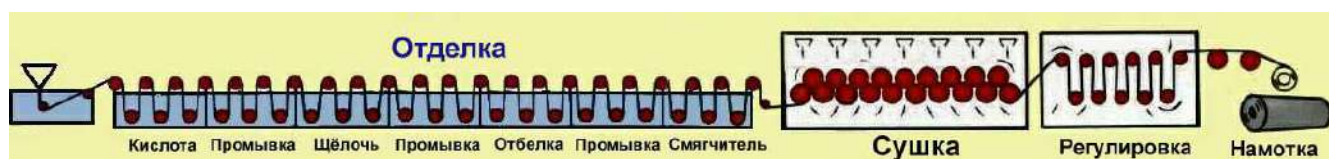
Рисунок 104 – Агрегат для формования целлофановой пленки [154]
