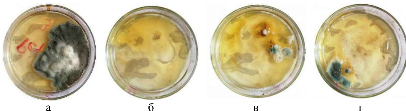
Рисунок 89 – Фотографии образцов целлофановой пленки после испытаний на стойкость к воздействию плесневых грибов: а – необработанный образец; б – модифицированный НЧ Cu-Ag при концентрациях прекурсоров \text{CuSO}_4 \cdot 5\text{H}_2\text{O} 0,3 мМ, \text{AgNO}_3 0,2 мМ; в – модифицированный НЧ Cu при концентрации \text{CuSO}_4 \cdot 5\text{H}_2\text{O} 3 мМ; г – модифицированный НЧ Ag при концентрации \text{AgNO}_3 0,2 мМ
