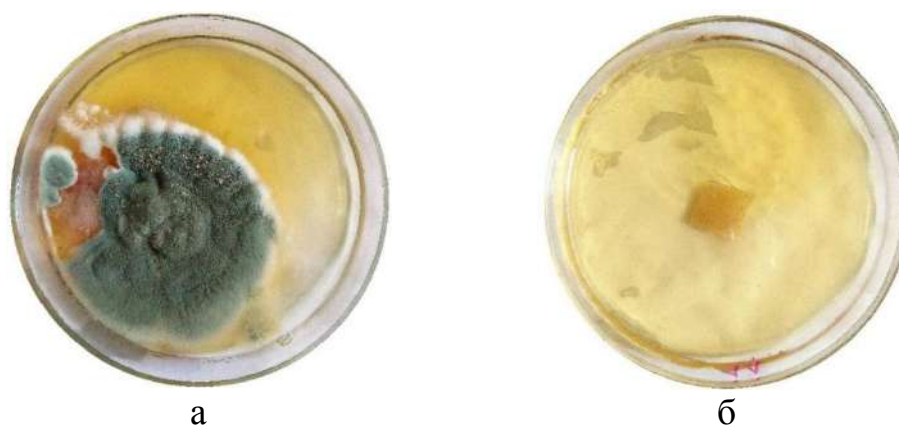
Рисунок 47 – Фотографии хлопчатобумажной ткани после испытаний на стойкость к воздействию плесневых грибов: а – необработанный образец; б – образец, модифицированный НЧ Cu-Ag при концентрации прекурсоров 0,3 мМ CuSO 4 ·5H 2 O, 0,2 мМ AgNO 3
