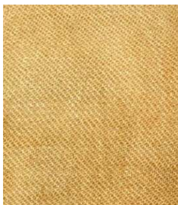
Рисунок 59 – Фотографии волокнистых материалов из белковых волокон, модифицированных бикомпонентными наночастицами Cu-Ag:
