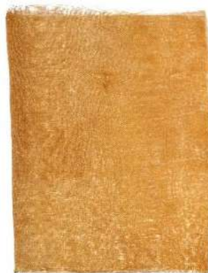
Рисунок 59 – Фотографии волокнистых материалов из белковых волокон, модифицированных бикомпонентными наночастицами Cu-Ag:
