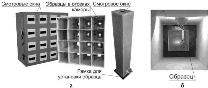
Рисунок 3 – Камеры наблюдения: а – многопозиционная (в закрытом и открытом состояниях) и однопозиционная; б – отсек камер
