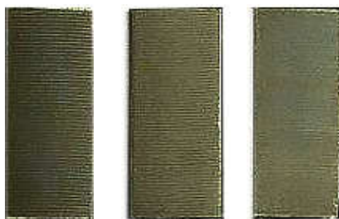
Рисунок 6 – Образцы алюминия после нанесения покрытия (слева направо) Образец с параметром шероховатости Ra = 5.0 , образец с параметром шероховатости Ra = 4.1 , образец с параметром шероховатости Ra = 2.2
